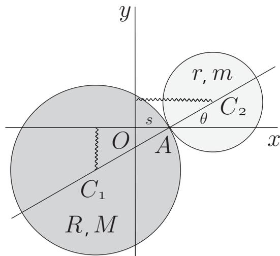
Utilizzando le coordinate lagrangiane  $s$  (ascissa di  $A$ ) e  $\theta$  (angolo della retta passante per i centri con l'asse  $x$ ) indicate in figura, determinare le configurazioni di equilibrio e studiarne la stabilità.
