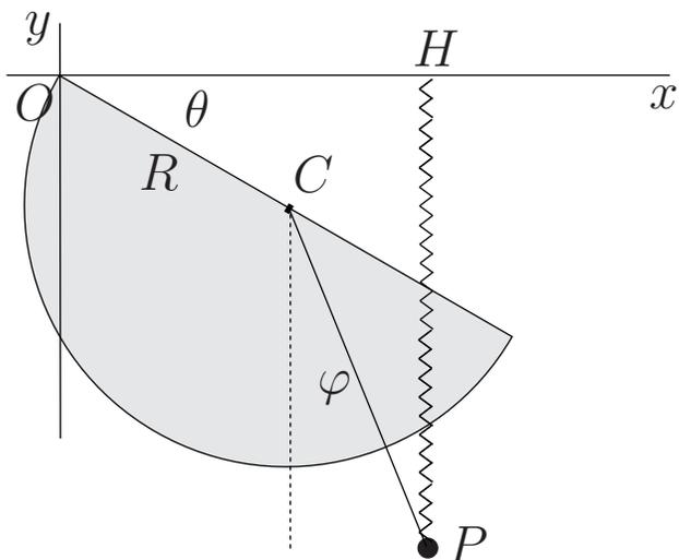
Utilizzando le coordinate lagrangiane  $\theta$  e  $\varphi$  indicate in figura, scrivere le equazioni di Lagrange per il sistema.
