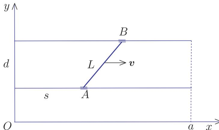
**Svolgimento.** Fino a quando gli estremi  $A$  e  $B$  rimangono sulle guide l'asta possiede zero gradi di libertà, perchè il suo moto è completamente noto. Da quando si libera solo l'estremo  $B$  l'asta possiede un grado di libertà (rotazione attorno ad  $A$ ); da quando anche  $A$  si libera il numero di gradi di libertà è pari a tre.
