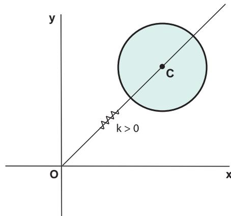
Infine, calcolare la reazione vincolare nel punto  $C$ .
